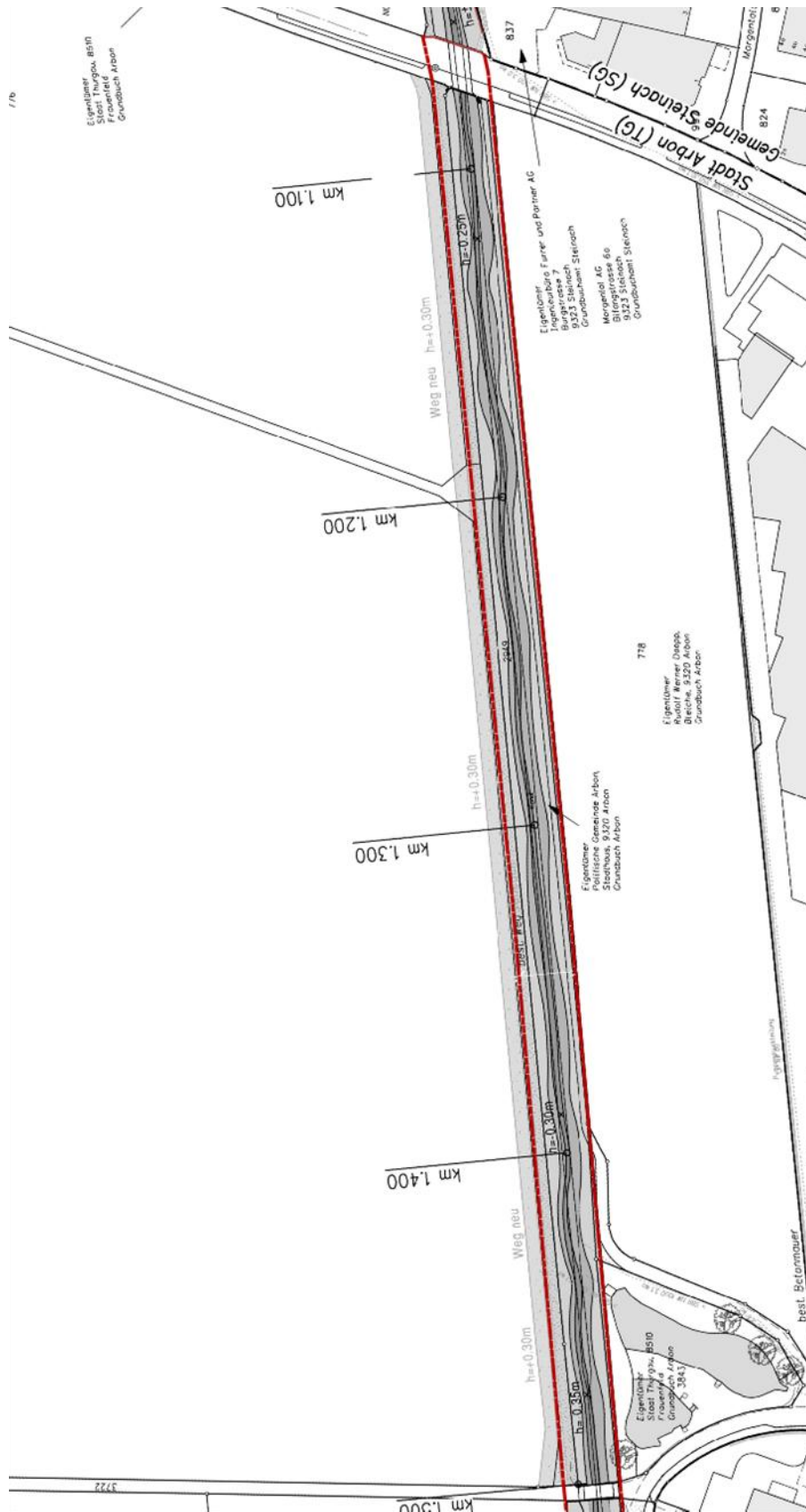
Abbildung 4: Gewässerraumlinien am Salbach zwischen Landquartstrasse und Kupferwiesenstrasse (rote Linien). Hinterlegt ist der Situationsplan gemäss Hochwasserschutzprojekt AachPlus (Vorprojekt, Gruner Böhlinger AG, 05.06.2015). In Abstimmung auf das Hochwasserschutzprojekt AachPlus wird der Gewässerraum im Bereich der Weiher lokal asymmetrisch nach Norden verschoben gegenüber der heutigen Bachachse.
